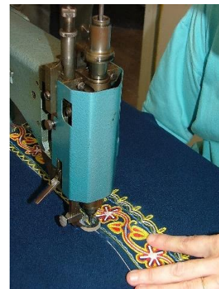
III. 3. Broderie à la machine Cornely dans l'atelier de la maison Le Minor. © Hélène Cario, 2007.
