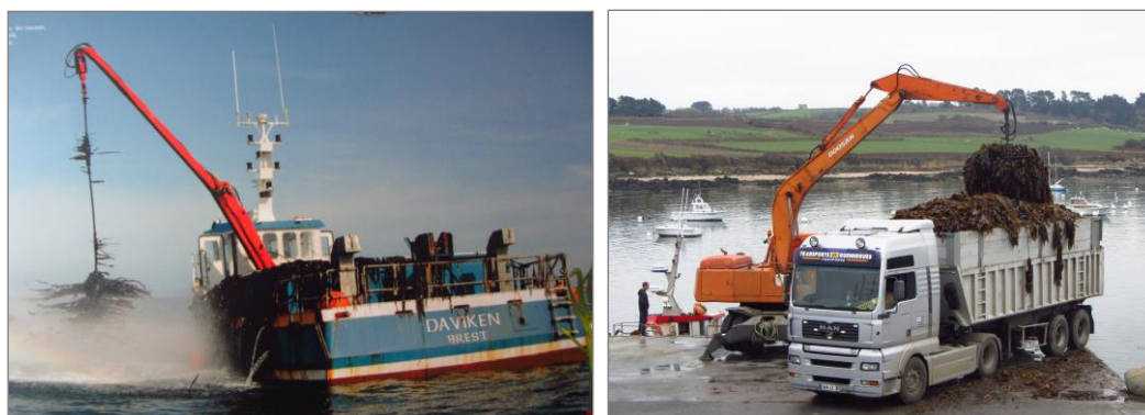
Goémonier équipé du skoubidou hydraulique en pêche (Maison de l'Algue) Déchargement du goémon, la laminaria hyperborea, à Lanildut, 2013
