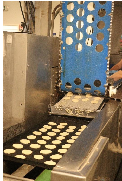
Illustrations 16a et 16b – Quand le procédé est mécanisé, la personne chargée de plaquer est guidée par un tapis prédécoupé sous lequel sont positionnées les plaques de cuisson.
