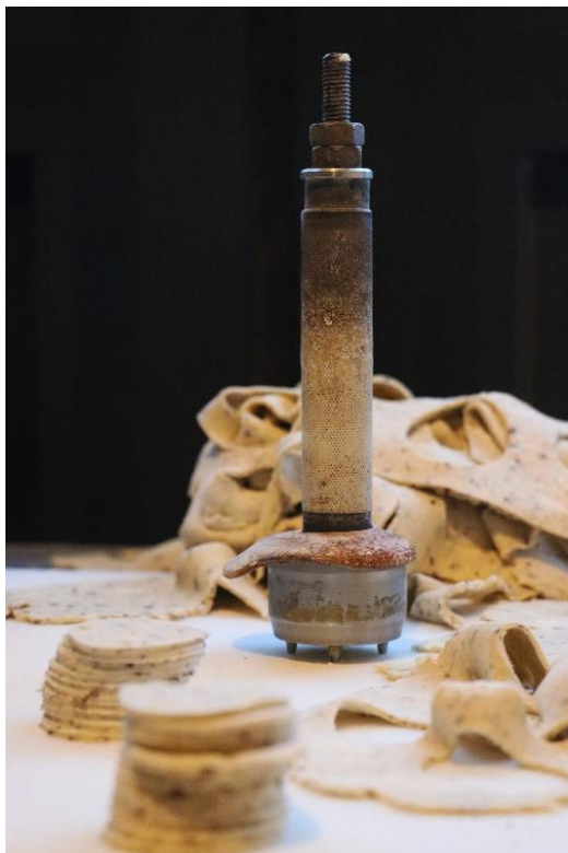
Illustration 24 - Emporte-pièce permettant de découper manuellement les petits craquelins. Photo : Julie Léonard, 2023.
