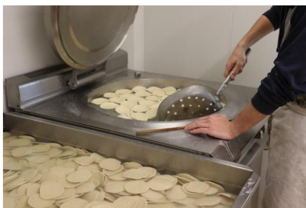
Illustration 13 - Utilisation d'une harassoire pour sortir les craquelins de la chaudière. Photo : Julie Léonard, 2023.
