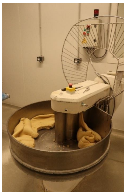
Illustration 3 - Raffineur avec deux rouleaux en vertical. Photo : Julie Léonard, 2023.
