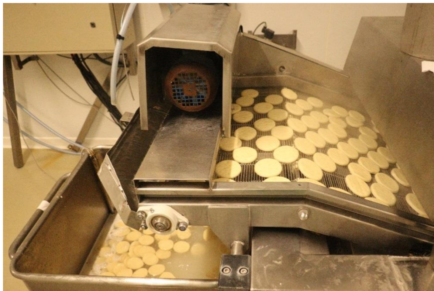
Illustration 9 - Sortie de la chaudière des craquelins échaudés.
