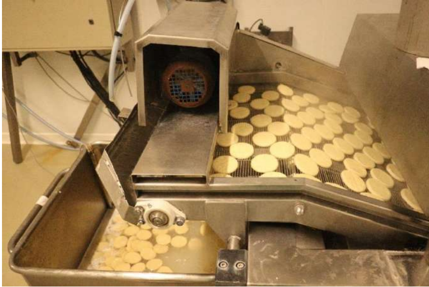
Illustration 9 - Sortie de la chaudière des craquelins échaudés.
