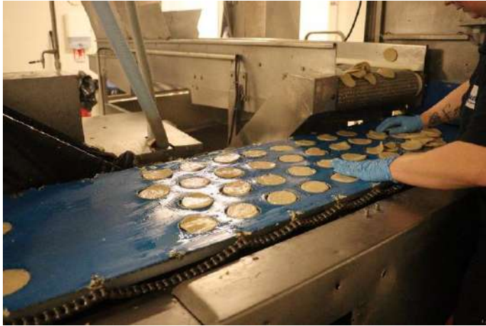
Illustrations 16a et 16b – Quand le procédé est mécanisé, la personne chargée de plaquer est guidée par un tapis prédécoupé sous lequel sont positionnées les plaques de cuisson.
