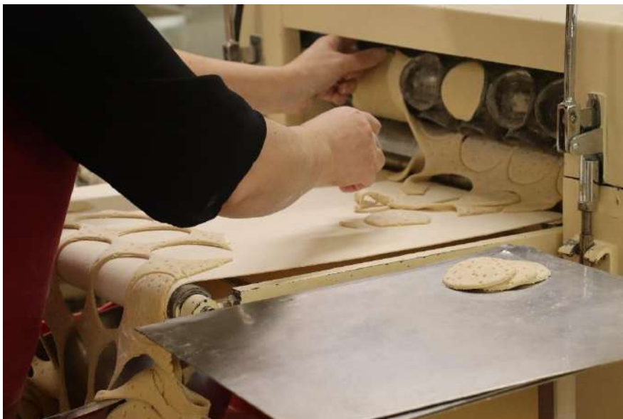
Illustration 7 - Emporte-pièce mécanique découpant la pâte au format souhaité, ici des craquelins dits classiques. Photo : Julie Léonard, 2023.
