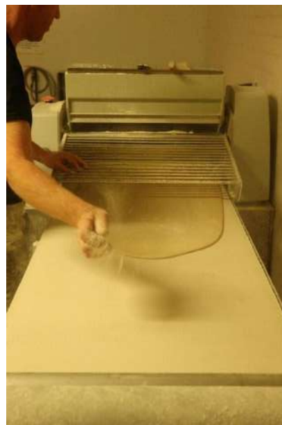
Illustration 5 - La pâte est farinée à la sortie d'un passage dans le laminoir.
