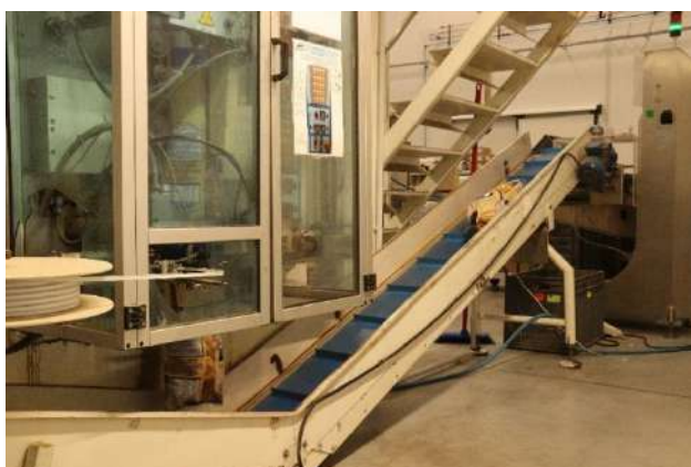
Illustrations 22a, 22b, 22c et 22d - L'ensachage des craquelins se fait manuellement ou à l'aide d'une machine automatisée.
